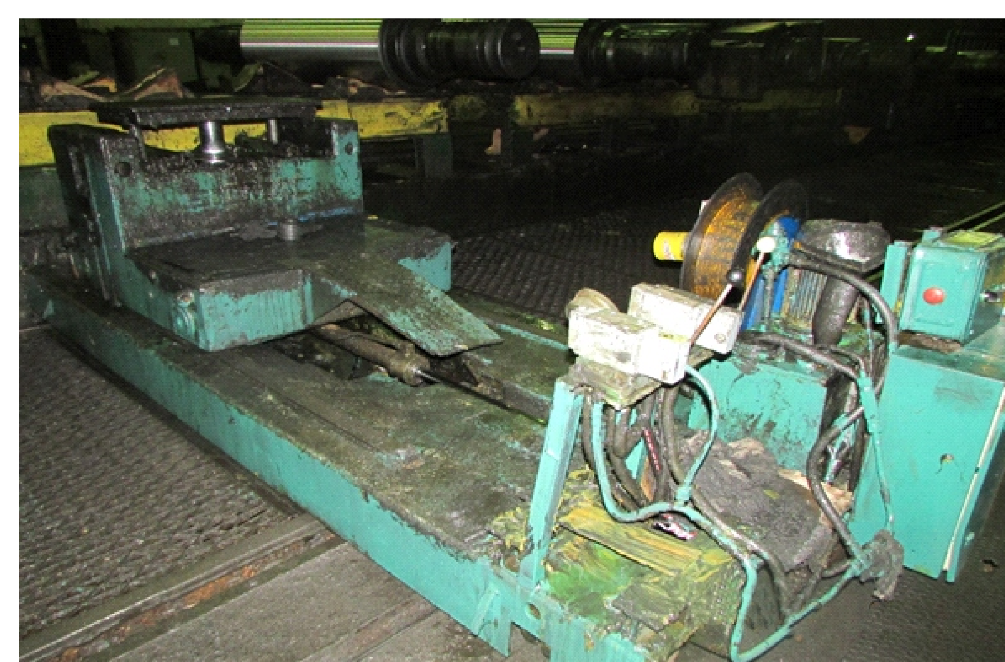
Fig. 2. Stand hidraulic de montare a casetelor cilindrilor de laminare - versiune ArcelorMittal
