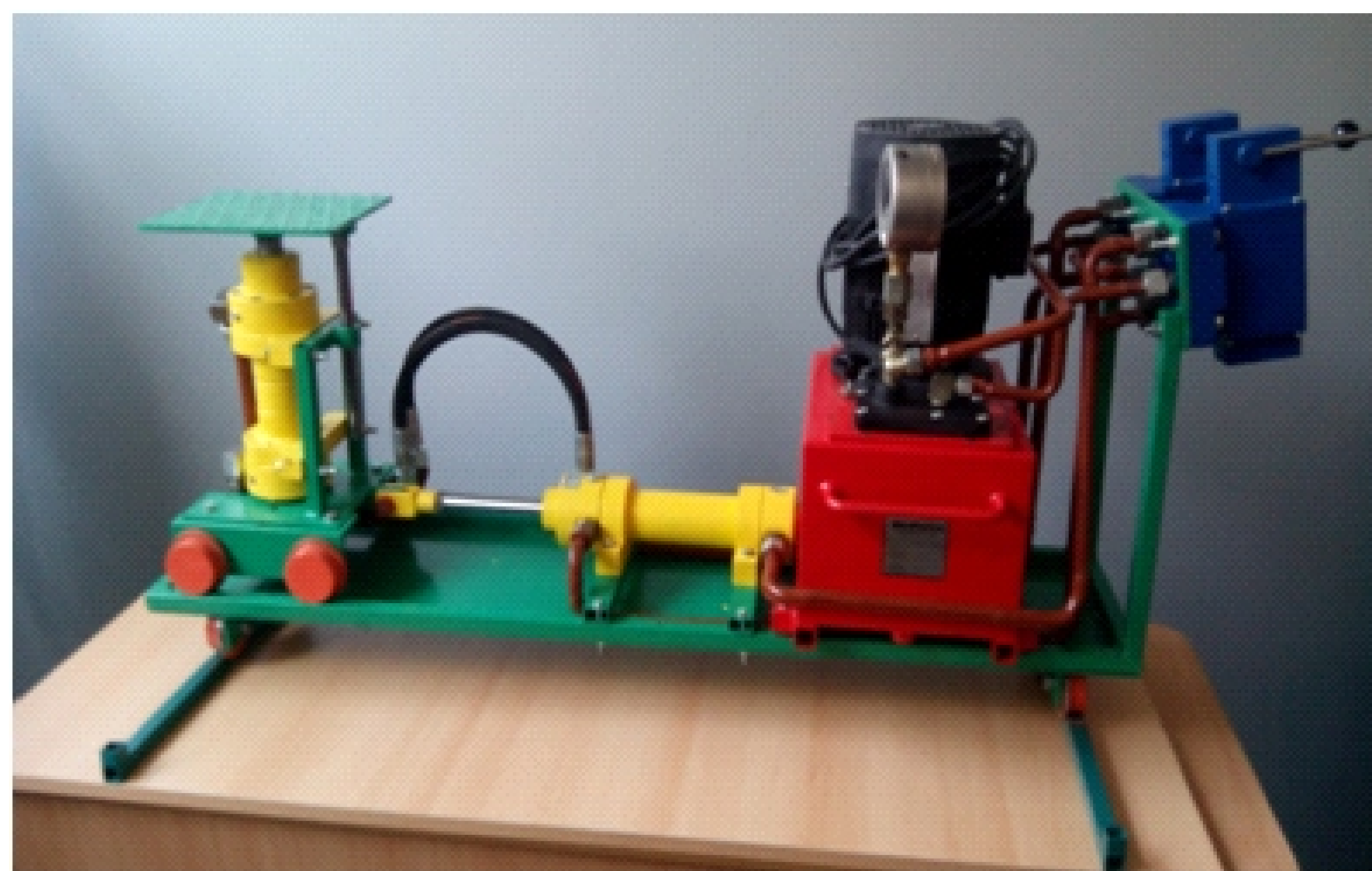
Fig. 3. Stand hidraulic de montare a casetelor cilindrilor de laminare - versiune laborator
